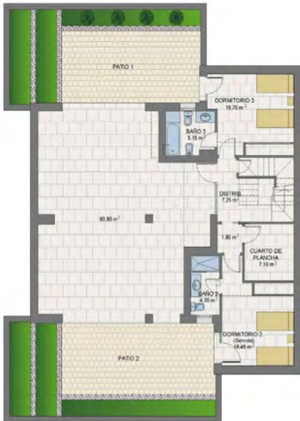
PLANTA BAJO RASANTE DE VIVIENDA TIPO
